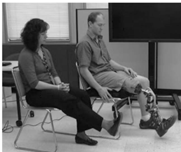
그림 4. 근전도 신호를 사용한 의지적 제어(Volitional Control)를 통해 좌측 정상인의 동작을 따라 움직이는 실험.
